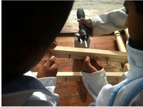
Nota: Colocación de pijas y taquetes (columnas) en el bastidor (lateral). Archivo personal.
